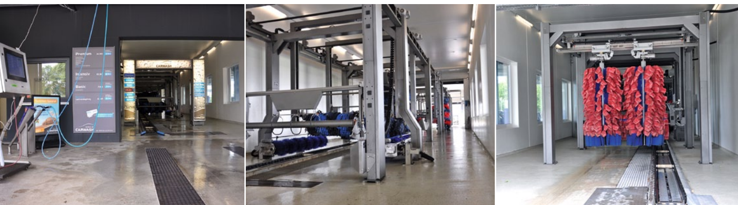
Durchfahrtsstationen der Autopflege (v.l.n.r.): Vom Start am Vorwaschplatz über mitfahrende Wasch- und Trocknerwalzen, die länger und besser einwirken.
