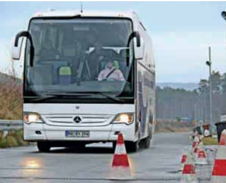
Bei der Zielbremsung soll der Tourino so nah wie möglich vor dem Kegel zum Stehen kommen. Die Probanden tasten sich von Versuch zu Versuch heran.
