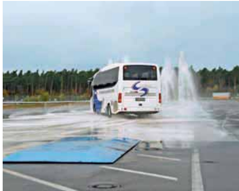
Die Rüttelplatte versetzt dem Tourino einen Schlag, sodass diesem auf nassem Belag das Heck ausbricht. Der Fahrer bremst und steuert gegen, wobei ihm ESP hilft.
