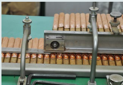
Packend akkurat: Die Shortfiller Vasco da Gama bekommen Zedernhülle und Ringe verpasst.
